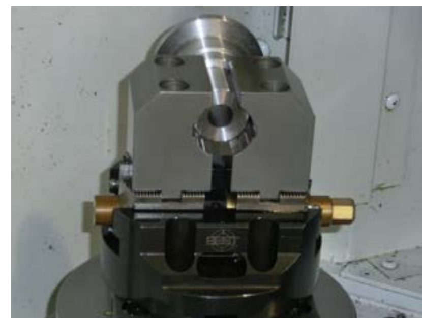
BSM-140 con griffe da sagomare (personalizzate) per il serraggio di un pezzo rotante di 35 mm di diametro.
