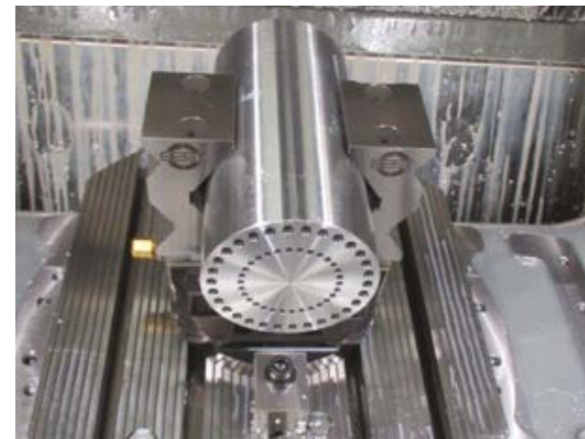
BSM-180 con griffe prismatiche 301-0120-003 (vedi pagina 40). I 3 prismi permettono di bloccare alberi da \varnothing 19 - 116 mm con una sola griffa.
