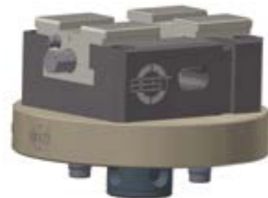
Esempio di adattamento di una morsa autocentrante senza attacco a punto zero su una piastra base.
